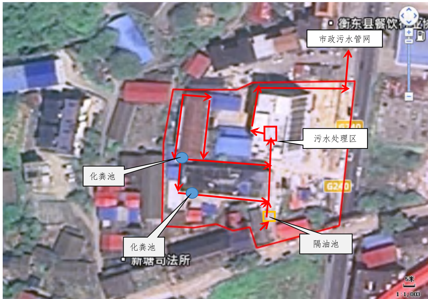
附图 3 污水走向示意图
